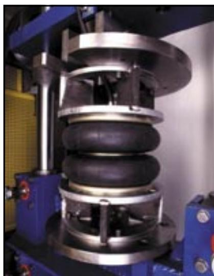
Вокруг пневматической пружины должно быть достаточно большое пространство, чтобы во время эксплуатации не произошло соприкосновение стенки сильфона с другими частями машины. Сильфон должен быть дополнен резиновым отбойником для предотвращения, при неожиданной утечке воздуха, соприкосновения резинотканевых гофров с металлическими крепёжными деталями и, соответственно, к возможному пробитию стенки сильфона.
